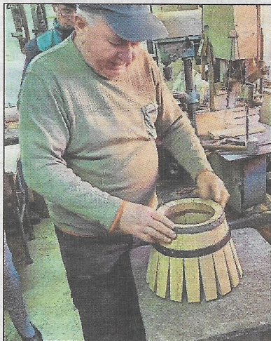
Der Fassmacher Istvan Donka spannt die Fassreifen über die Dauben.
